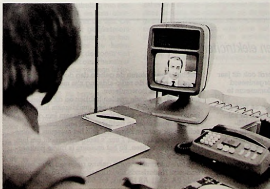
Afb. 4. Ir. Ouwehand van de PTT verwacht dat de beeldtelefoon nu echt op korte termijn wordt geïntroduceerd. Ondermeer omdat een nieuw systeem is ontwikkeld waardoor het beeld via een normale telefoonlijn kan worden verstuurd.
